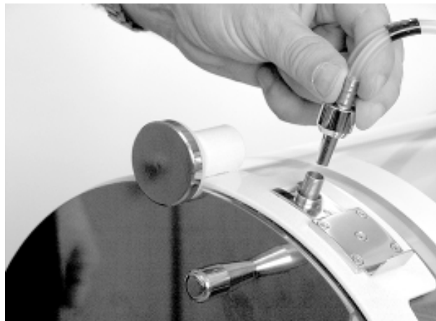
Рис. 2.1.11: Соединение трубки с наконечником манжеты для подачи давления .
