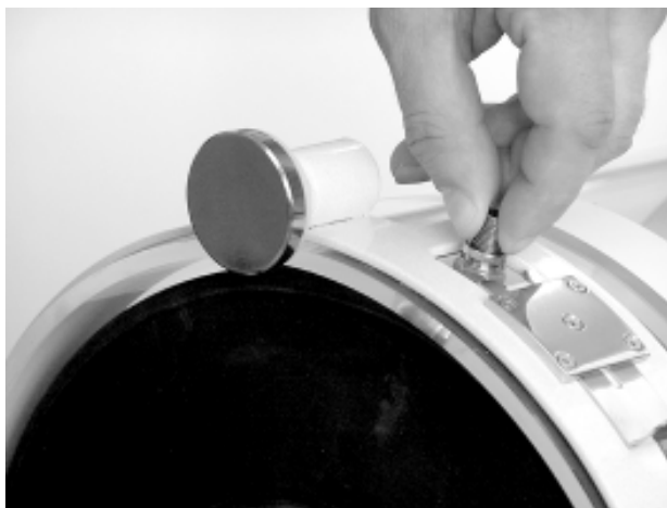
Рис. 2.1.7: Вытягивание наконечника манжеты наружу перед его фиксированием.
