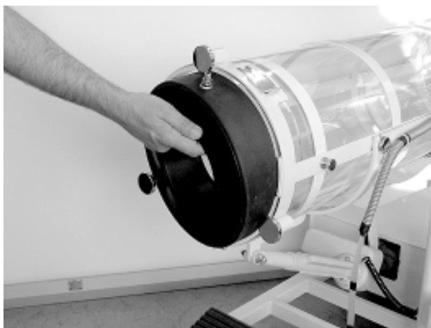
Рис. 2.1.6: Установка уплотнительной манжеты в горловине аппликационного цилиндра.
