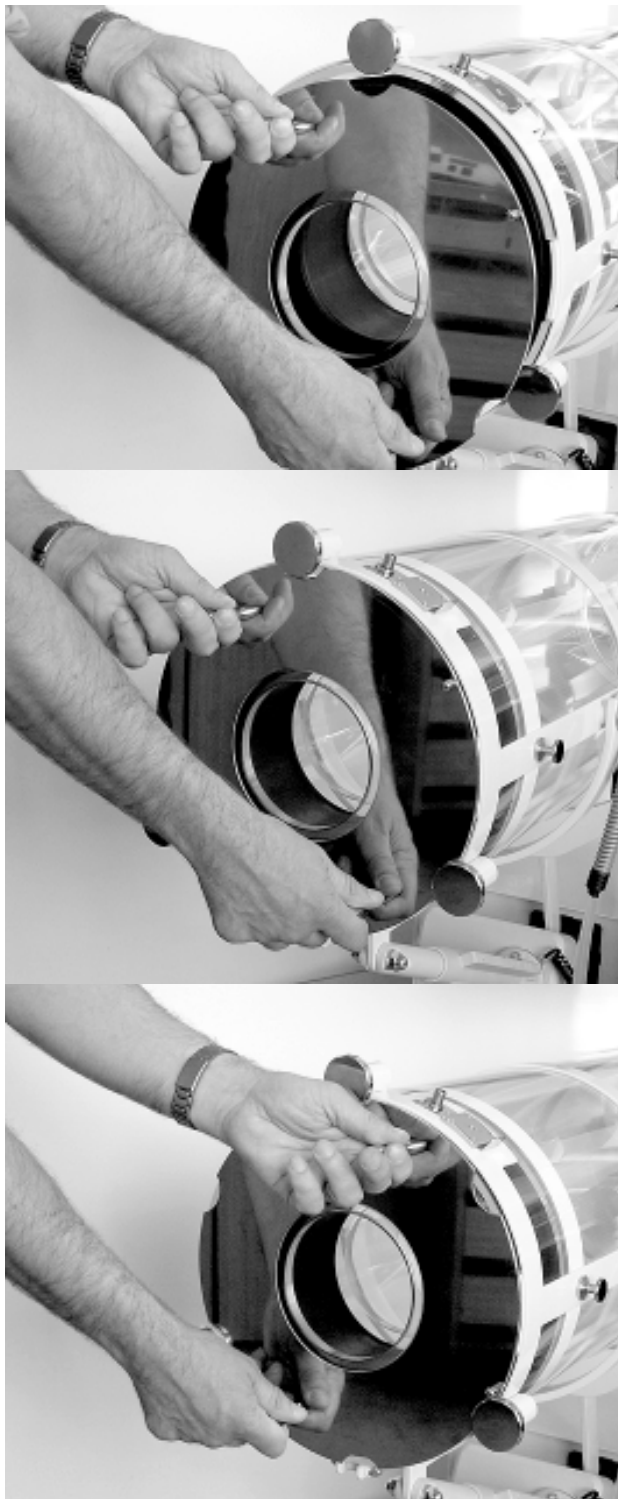
Рис. 2.1.9 а, б, в: Установка и фиксирование внешнего переходного кольца.
