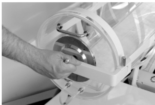
Рис.2.5.2а: Крышка снимается только при отключённом аппарате. Рукой или с помощью инструмента открутить винт с фиксирующим диском.
