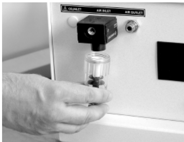
Рис. 2.5.1.: Сосуд с дезинфицирующим средством и возможностью обработки парами.
