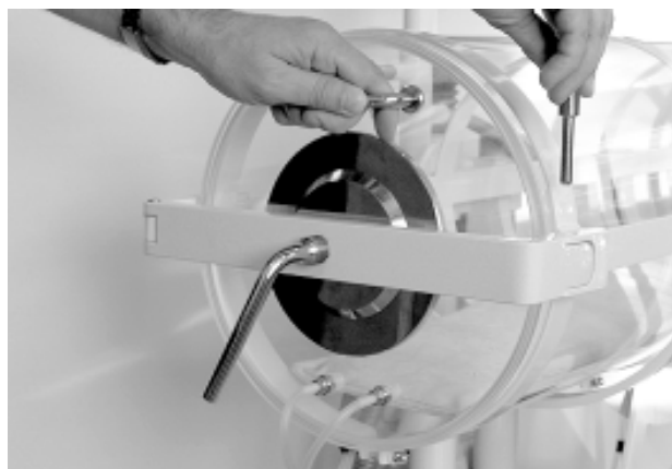
Рис. 2.5.2б: Придерживая крышку снять затычку.
