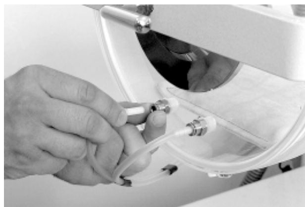
Рис.2.5.3: Снятие трубок с помощью быстросъемных соединений.
