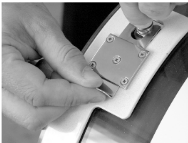
Рис. 2.1.8: Укрепление наконечника манжеты с помощью фиксатора.
