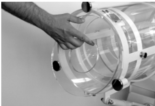
Рис. 2.1.5: Установка внутреннего переходного кольца в горловине цилиндра.
