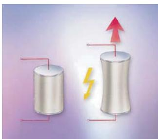
При активации высоковольтным импульсом цилиндрические пьезоэлементы за короткий промежуток времени увеличиваются в размерах на несколько микрометров вдоль своей оси
