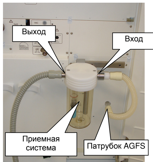
Рис. 78 система подачи анестезирующих газов с приемной системой
