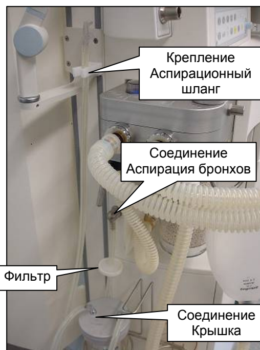
Рис. 87 подключение системы аспирации бронхов
