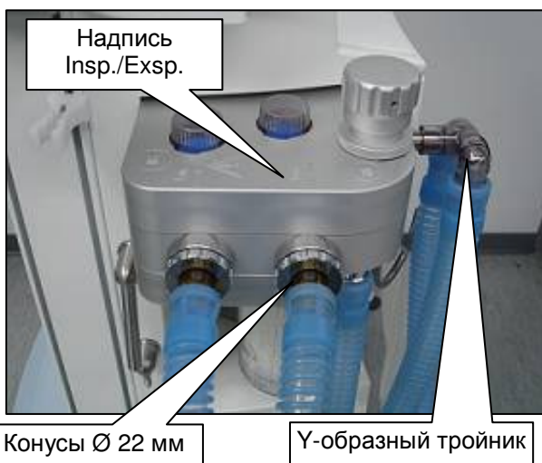
Рис. 73 подключение дыхательных шлангов
