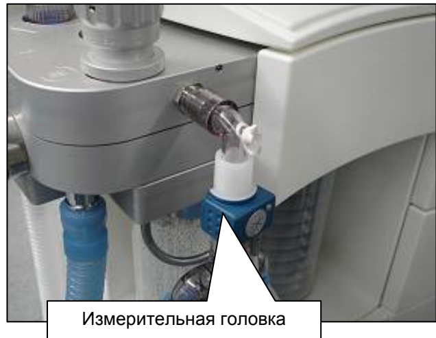
Рис. 85 подключение измерительной головки
