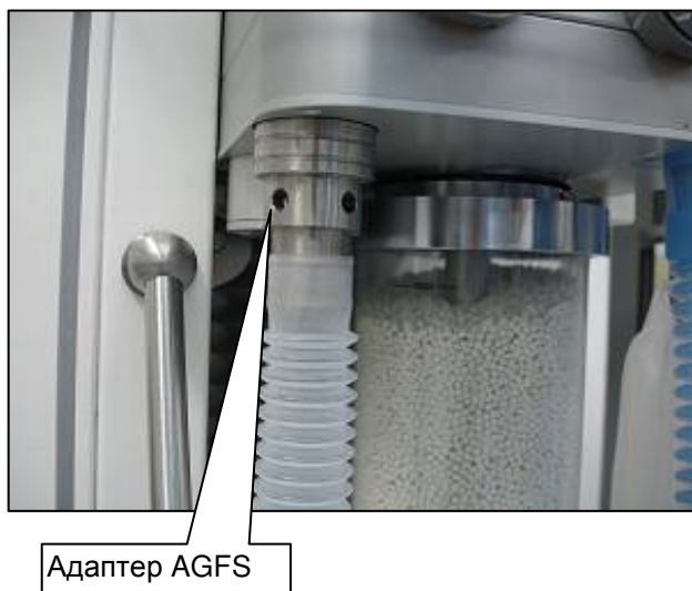
Рис. 76 подключение непосредственно к AGFS без приемной системы
