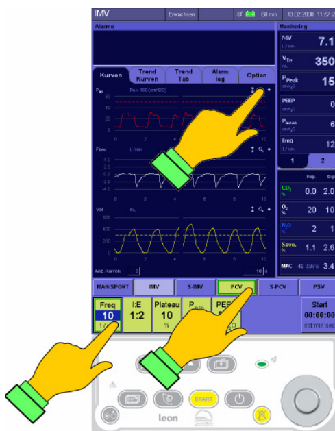
Рис. 11 управление с помощью сенсорного экрана
