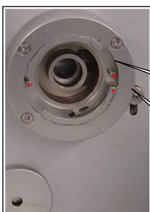
Рис. 47 положение поглотителя CO 2 крепление без поглотителя CO 2
