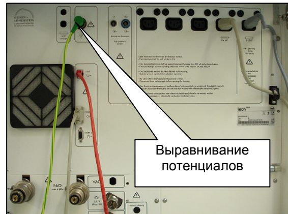
Рис. 62 подключение системы выравнивания потенциалов
