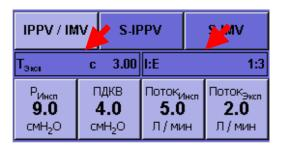
Дополнительные характеристики, зависящие от установленных параметров ИВЛ, отображаются между режимами ИВЛ и параметрами.
